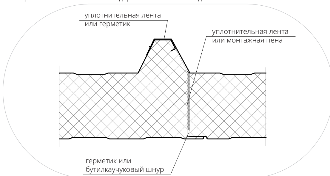
Рисунок 22. Стык кровельных панелей со стандартным замковым соединением
